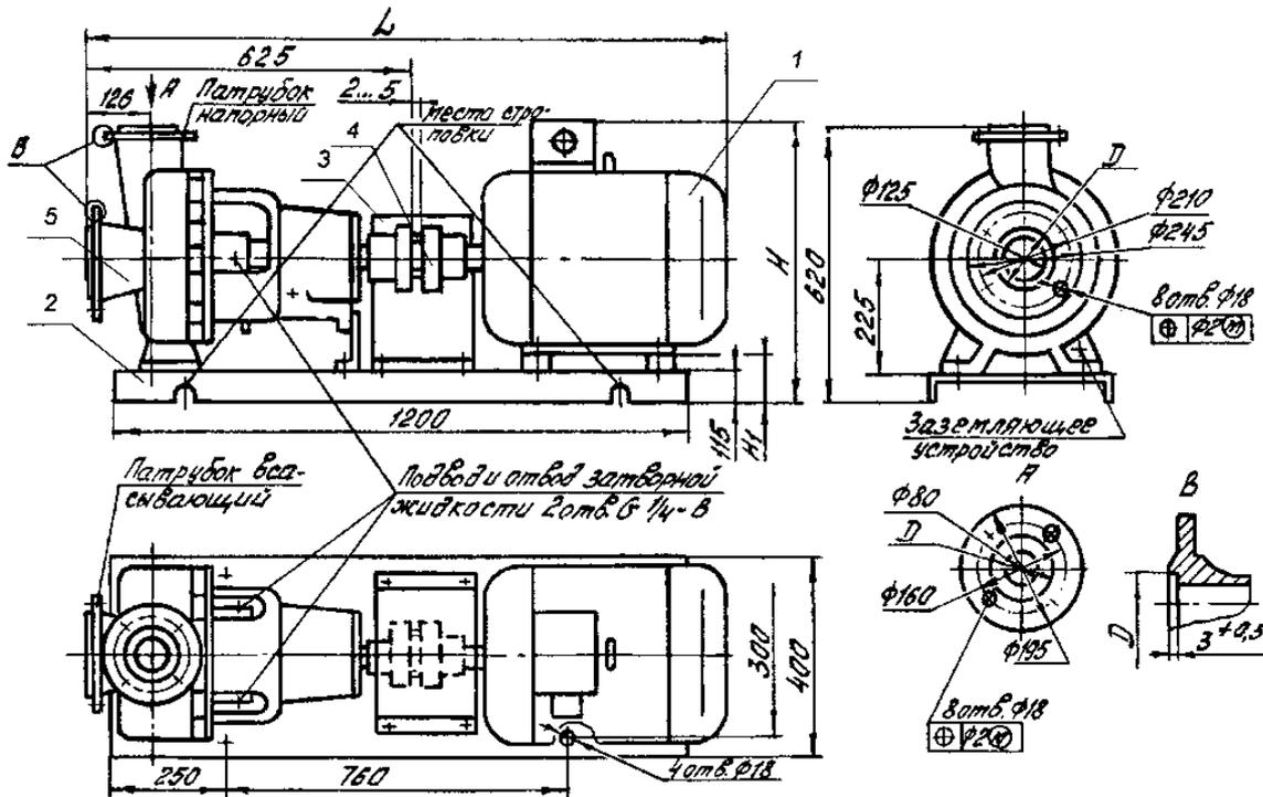
1 – двигатель, 2 – плита фундаментная, 3 – кожух защитный, 4 – муфта, 5 – насос центробежный
