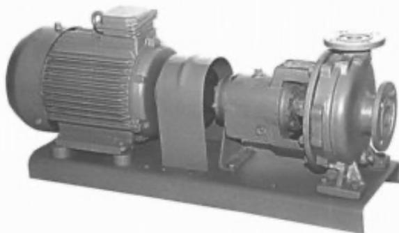
Агрегаты электронасосные марки АХ(О)(-Е)125-80-200/2 (в дальнейшем агрегаты) предназначены для перекачивания чистых нейтральных жидкостей кинематической вязкостью до  $30 \cdot 10^{-6}$  м<sup>2</sup>/с, имеющих твердые включения не более 1,0 мм, объемная концентрация которых не более 1,5 %, плотностью не более: 1000 кг/м<sup>3</sup>, с температурой перекачиваемой жидкости от 0 до + 120 °С.
