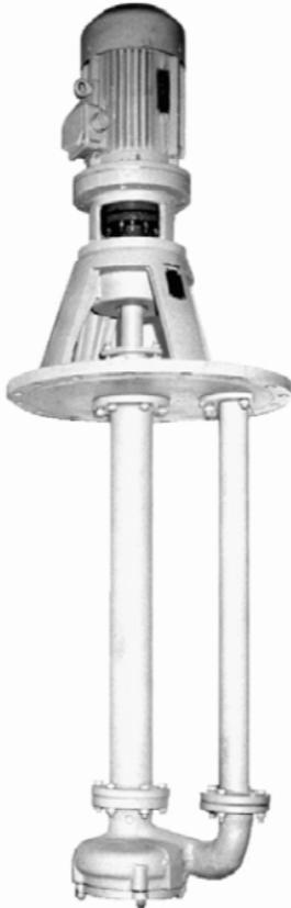
Агрегаты электронасосные марки АХП80-50-200 (в дальнейшем агрегаты) предназначены для перекачивания химически активных и нейтральных жидкостей плотностью не более 1850 кг/м<sup>3</sup>, кинематической вязкостью до 30×10<sup>-6</sup> м<sup>2</sup>/с, имеющих твердые включения не более 1,0 мм, объемная концентрация которых не более 1,5 % с температурой перекачиваемой жидкости от минус 40 до +90 °С для исполнения А и от минус 40 до +120 °С для исполнений К, К1, Е, И.
